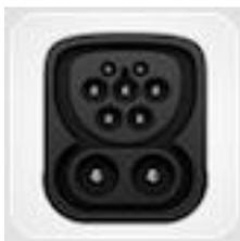
Typ-2 / CCS-Buchse am Fahrzeug (Das Ladekabel ist an den Ladesäulen befestigt.)
