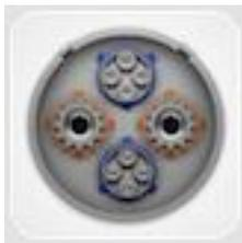
CHAdeMO-Buchse am Fahrzeug (Das Ladekabel ist an den Ladesäulen befestigt.)
